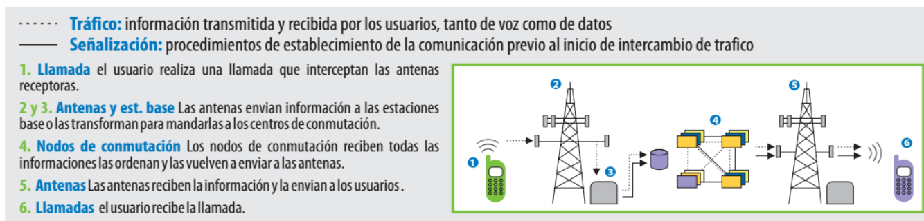
Figura 6. Diagrama de funcionamiento de la telefonía celular
